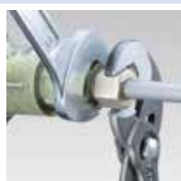
Schraubzange als zweiter »Schlüssel« bei Konterverschraubungen
