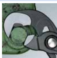
Arbeiten an fest-sitzender Schraube mit verrundeten Kanten
