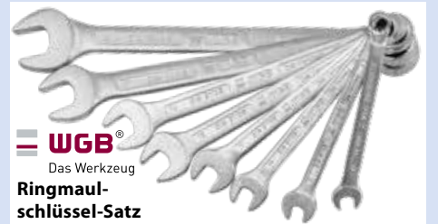
Ringmaulschlüssel-Satz DIN 3113 A, im Karton , abgewinkelt 15°, Chrom-Vanadium Stahl, verchromt
